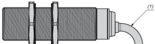
(1) 弯曲电缆：外部电缆直径的 4 倍
