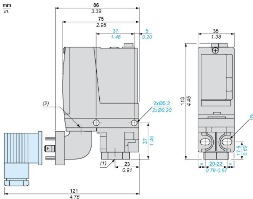
(1) 1个流体入口，带 G1/4 螺纹 (BSP 内螺纹)
